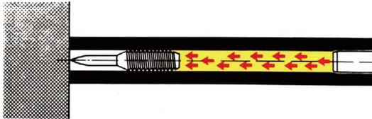
空包からのエネルギーはピンに直接すべて作用させて加速させ、母材の表面に高速で衝突させます。従ってそれら部材を貫通する危険が生じます。その上、例えば、ピンの進路に固い部分などがあった場合には、はね返ってその方向がそれる危険性もあります。
